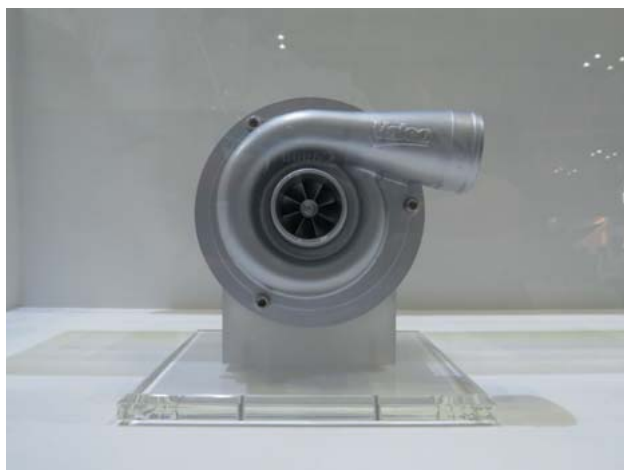
電動式スーパーチャージャ（株式会社ヴァレオジャパン） 現在主流の排ガスを利用するターボチャージャに対抗しターボラグや燃費を改善できるもの。 今後、欧州車に搭載される可能性が高いとのこと。
