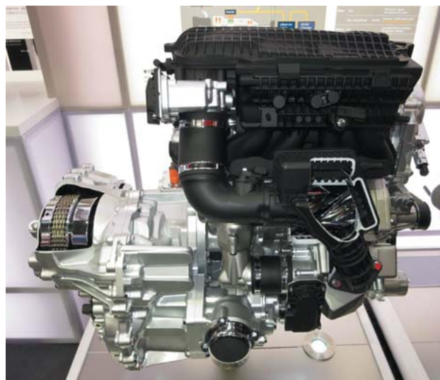
ハイブリッド用2.5ℓ スーパーチャージャ、電気モータ付エンジン（日産自動車株式会社）
