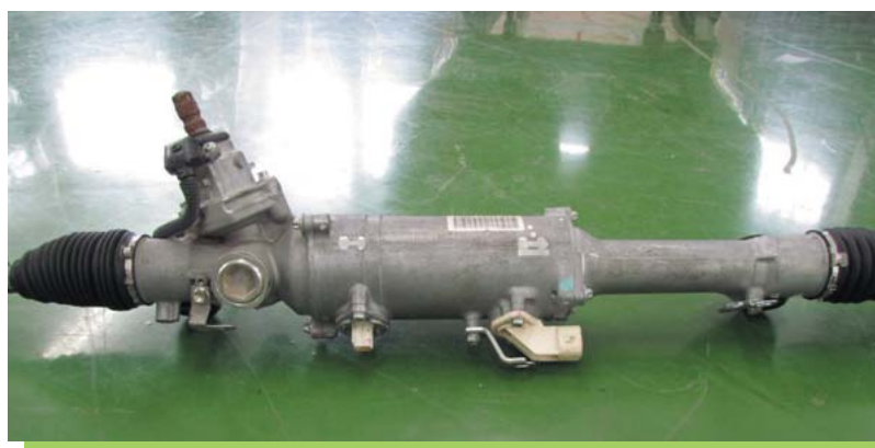
トヨタマークX GRX130系に採用された同軸式R-EPSの例
