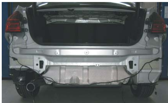
リヤバンパキャリア、リヤセンタガイド、両側サイドバンパガイド取外し状態
