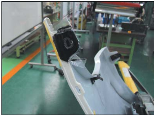
補修用樹脂で欠損部分を成型
