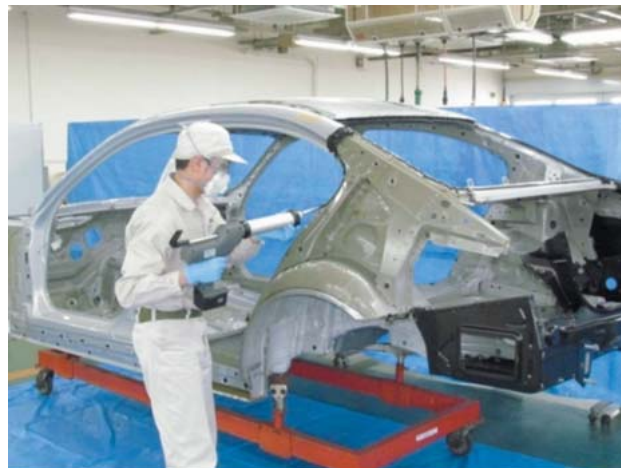
リアフェンダ取替作業
