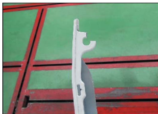
損傷頻度の高いバンパ端部
