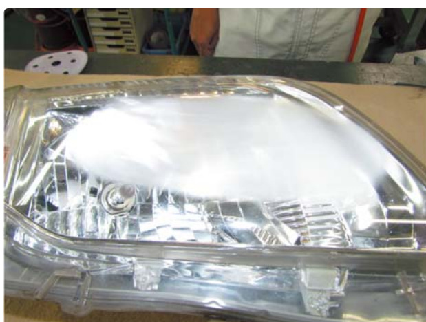
損傷部よりも一回り大きく600番で研磨
