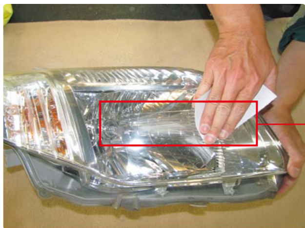
レンズ中央に180番のサンドペーパーで3回ほど擦り、爪に引っかかる程度の傷を作成。
