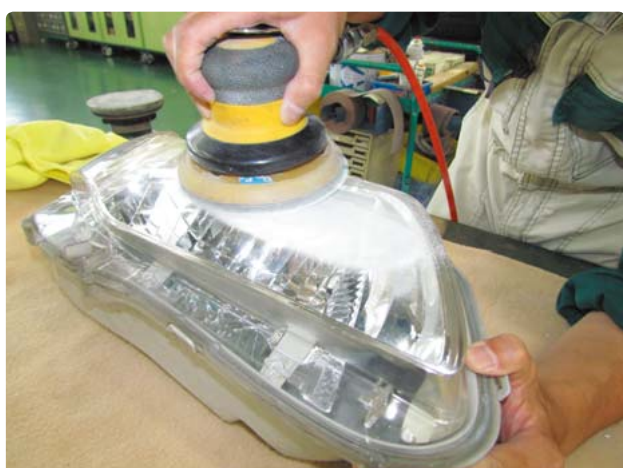
損傷部よりも一回り大きく600番で研磨
