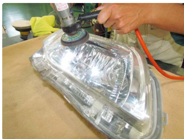
極細コンパウンドによる研磨
