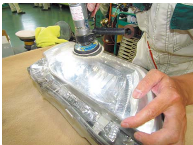
細目コンパウンドによる研磨
