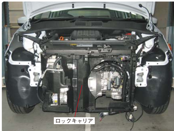
左側フェンダ取外し状態
