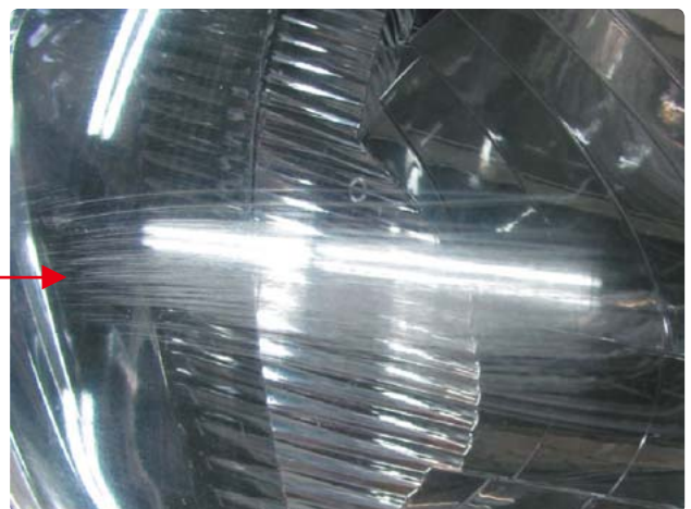
レンズ中央に180番のサンドペーパーで3回ほど擦り、爪に引っかかる程度の傷を作成。
