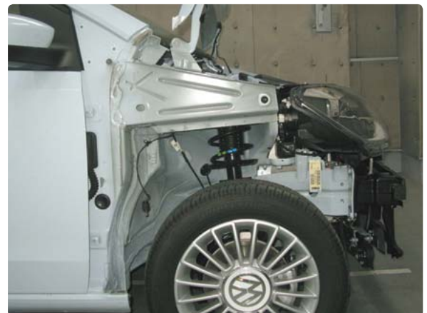
右側フェンダ取外し状態
