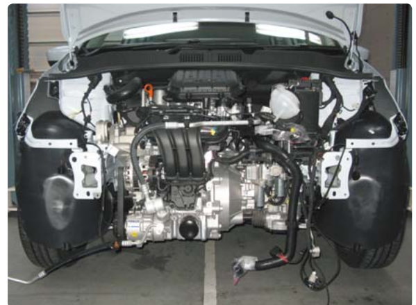
右側フェンダ取外し状態
