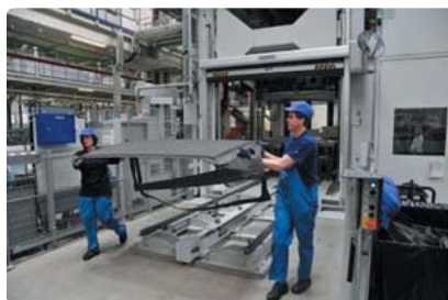
完成したCFRP製のパネルは、不要部分の切断と穴あけ加工が施される。
