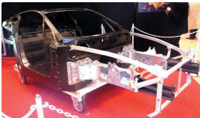
レクサスLFAのホワイトボデーとBピラー付近の様子。プリプレグ、RTM、SMCが混在。
