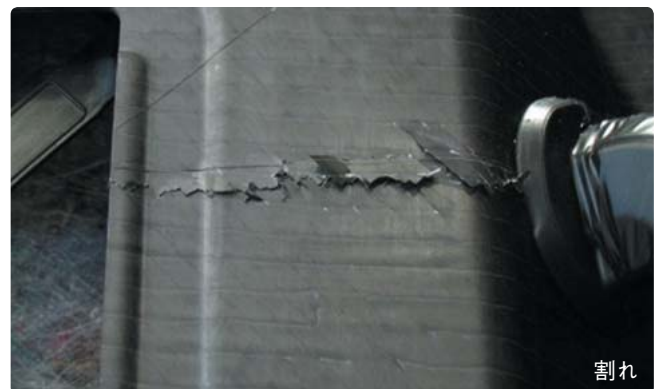
CFRP には「擦過傷」や「割れ」といった現象は現れるが、「曲り」は生成されにくい。
