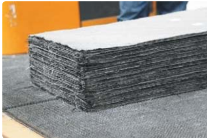
積層、裁断されたCFを金型プレスで予備成形し、樹脂を注入して繊維と樹脂を結合させる。
