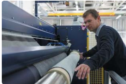
CFを撚り合わせて荒糸を作り、それを織って布状にすることで構造体の原料になる。
