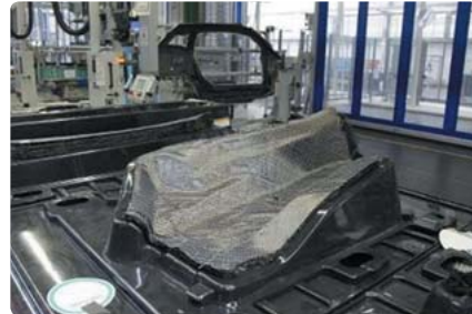
積層、裁断されたCFを金型プレスで予備成形し、樹脂を注入して繊維と樹脂を結合させる。
