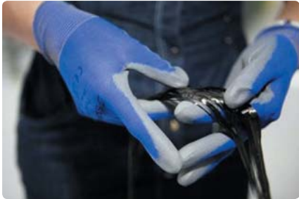
CFを撚り合わせて荒糸を作り、それを織って布状にすることで構造体の原料になる。
