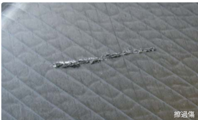
CFRP には「擦過傷」や「割れ」といった現象は現れるが、「曲り」は生成されにくい。
