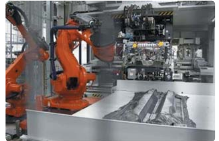
積層、裁断されたCFを金型プレスで予備成形し、樹脂を注入して繊維と樹脂を結合させる。
