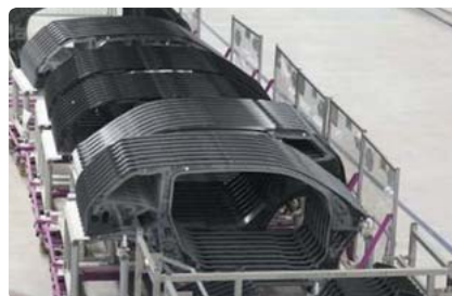
完成したCFRP製のパネルは、不要部分の切断と穴あけ加工が施される。
