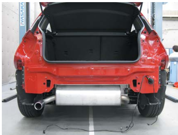
リヤバンパキャリア、センタガイド、両側サイドバンパガイド取外し状態
