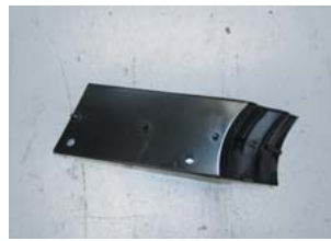
Cピラー補強プレート 品番 左側:41 00 7 284 391 右側:41 00 7 284 392
