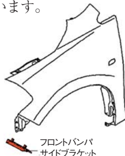
図2 フロントバンパ取替指数に含まれていない部品
