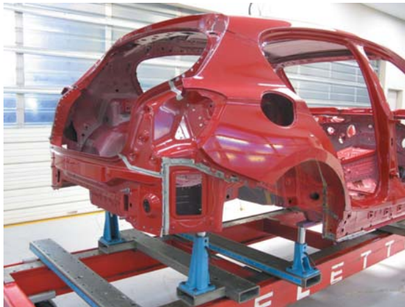
Cピラー補強プレート 品番 左側:41 00 7 284 391 右側:41 00 7 284 392
