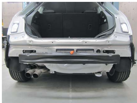
バンパカバー取外し状態
