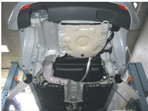
インタミディエイトパイプ、ツインテールパイプ 付きリヤサイレンサ取外し状態
