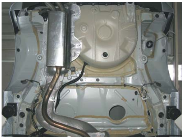
フューエルタンク取外し状態
