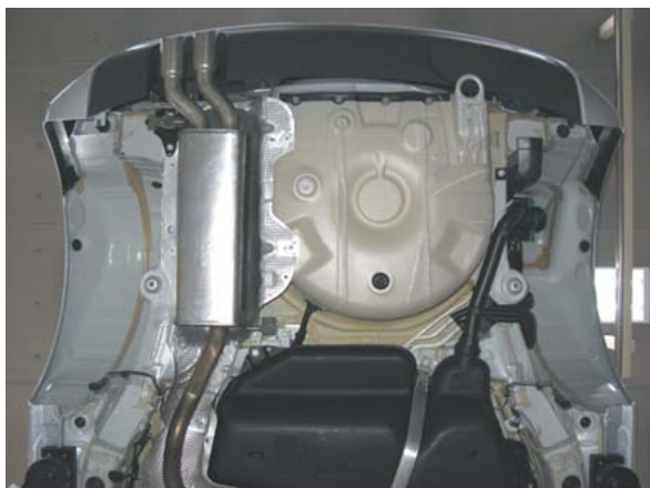
リヤサスペンション取外し状態
