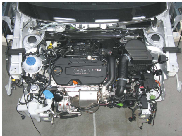
エンジン取付状態（上側）
