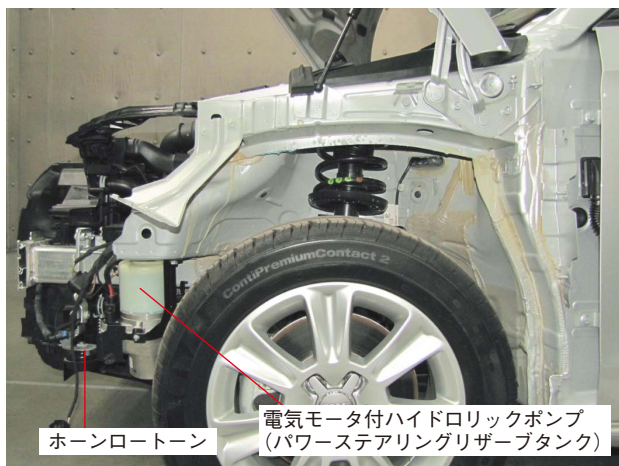
左側フロントフェンダ取外し状態
