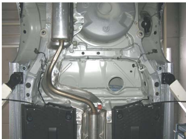
フューエルタンク取外し状態
