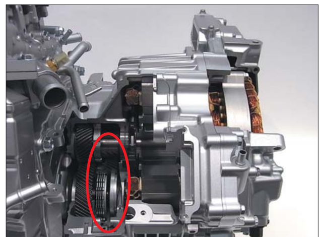
エンジン直結クラッチ(赤丸部分がクラッチ)
