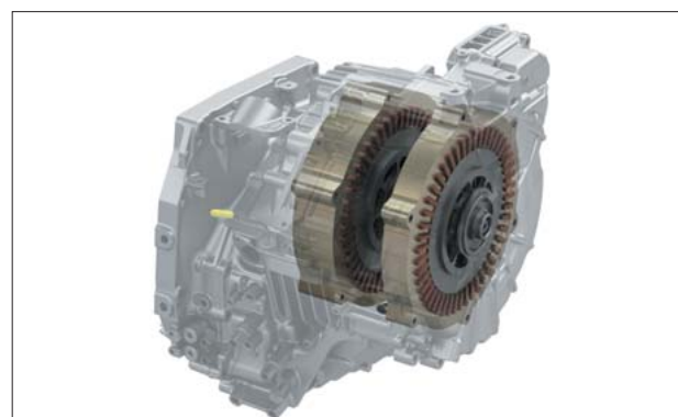
2モータ(写真左側 → 走行用、写真右側 → 発電用)
