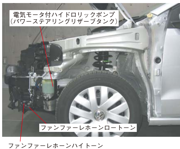
左側フロントフェンダ取外し状態
