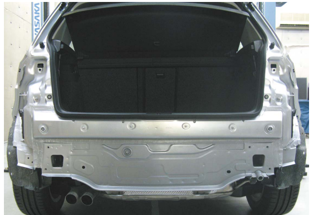
バンパラインホースメント、両側ガイドピースリヤ、リヤバンパロックストリップ取外し状態
