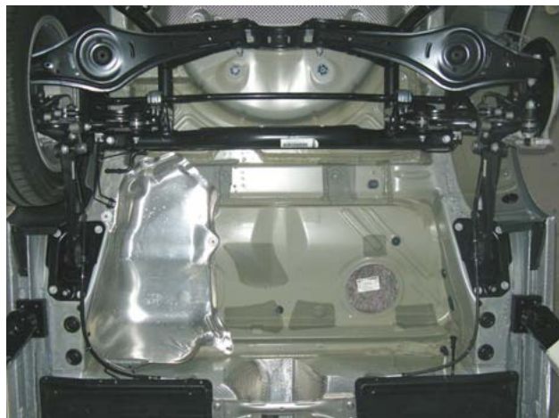
リヤサスペンション取外し状態
