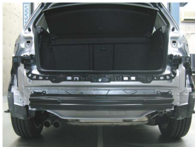
バンパカバーリヤ取外し状態
