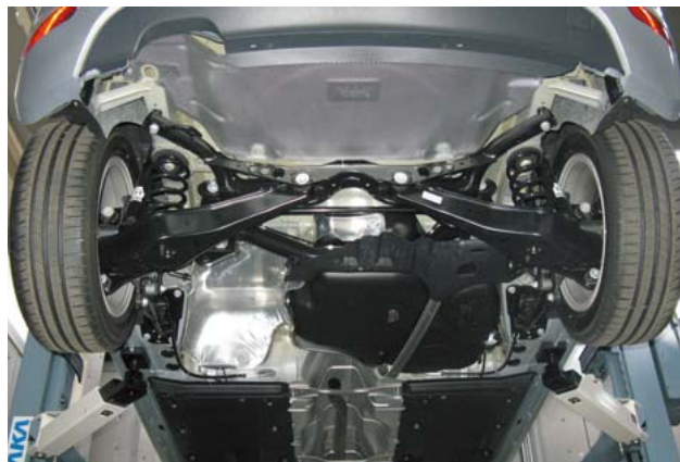
フューエルタンク取外し状態
