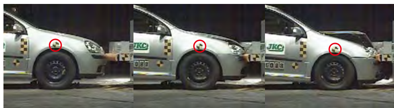
図7 車両側面のターゲット
