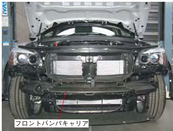
トリムパネルフロントバンパ取外し状態
