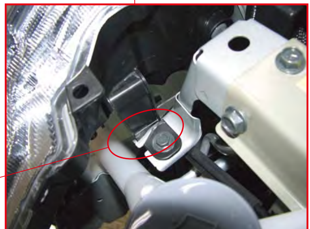
写真3 右ヘッドランプブラケット部損傷
