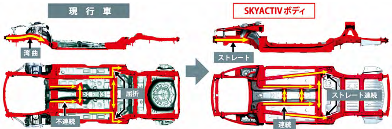
図5 基本骨格のストレート化、連続化技術
