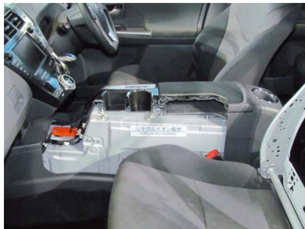
センターコンソールボックス内に配置されるリチウムイオンバッテリー
