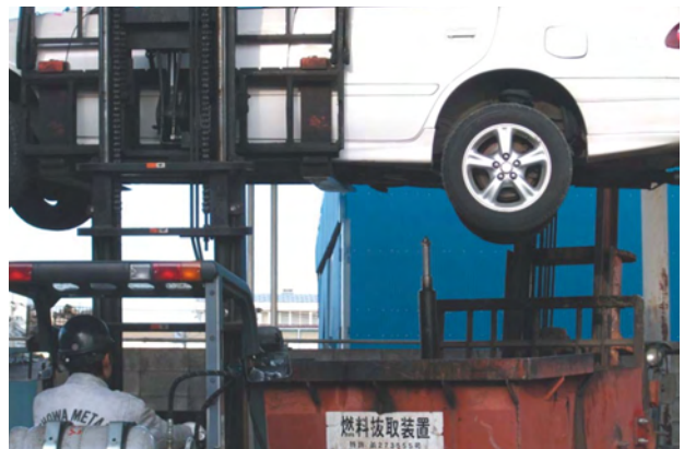
燃料の抜き取り作業
