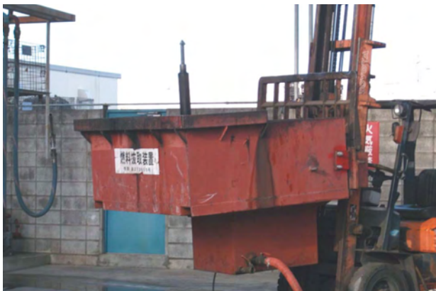
燃料抜き取装置
