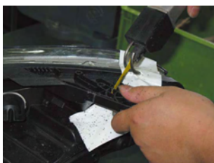
リペアソリューションフォーヘッドランプスブラケットに合わせて損傷部を切断する。
