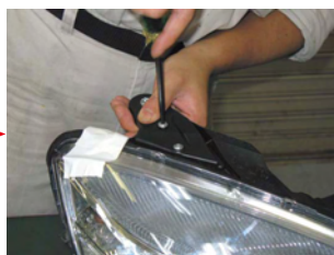
スクリューで受け穴に取付ける。 完成。
