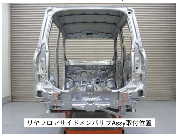
写真7 リヤ正面ボデーローバックパネルサブAssy、 ボデーローバックパネルサブAssyインナ取外し状態
