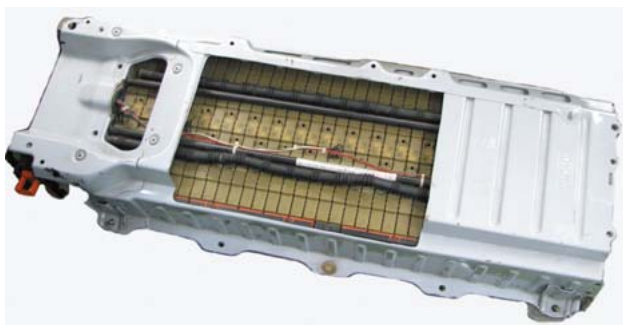
NHW11型に搭載 7.2V/M*38M (総電圧273.6V)
