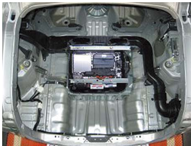
インサイトのインテリジェントパワーユニット部 ニッケル水素電池を使用 （プロテクトカバーを外したときのイメージ図）
