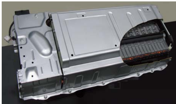
ZVW30型に搭載 7.2V/M*28M (総電圧201.6V)
