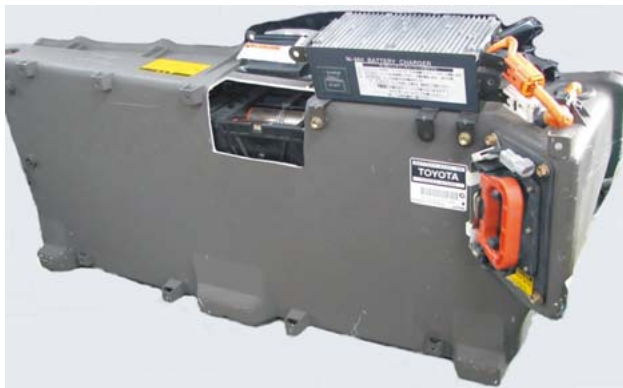
トヨタ プリウス NHW10型に搭載 7.2V/M*40M (総電圧288V)
