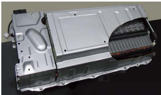
プリウス（ZVW30）に搭載されているHVバッテリー ニッケル水素電池を使用
