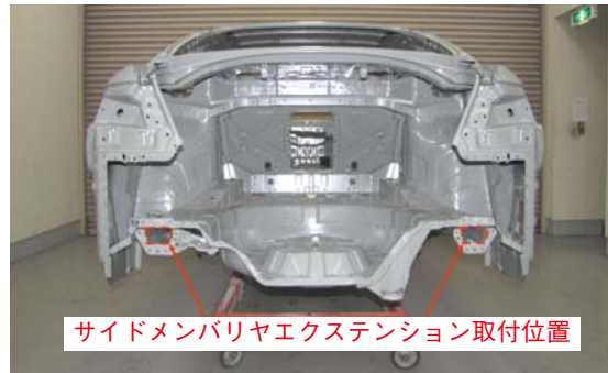
リヤ上面 (リヤリヤフロアおよびリヤリヤサイドフロア取外し状態)
