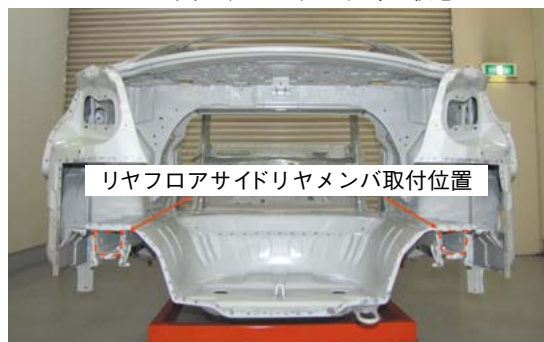
リヤ上側リヤフロアリヤパネル取外し状態
