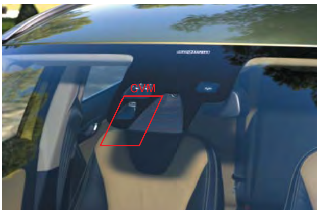
左上の写真はフロントウインド上端部に配置されるCVMの取り付け位置を示す。 右上の写真はCVMをフロントウインドより取り外し、前方より撮影したもの。
