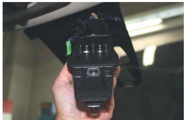
左上の写真はフロントウインド上端部に配置されるCVMの取り付け位置を示す。 右上の写真はCVMをフロントウインドより取り外し、前方より撮影したもの。
