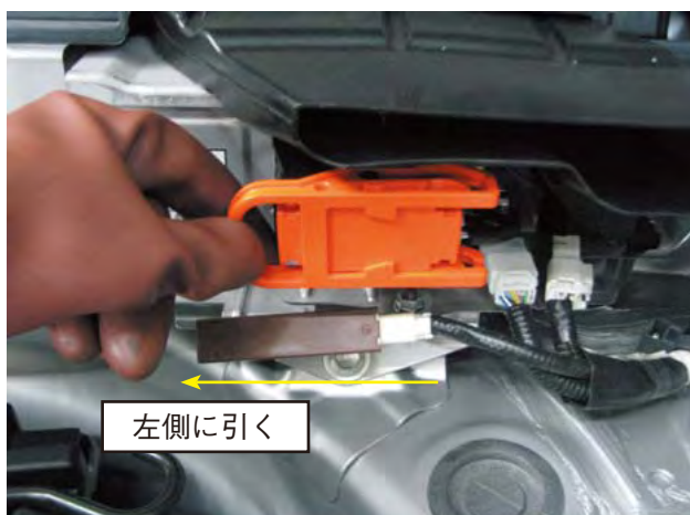
写真12 サービスプラググリップの取外し
