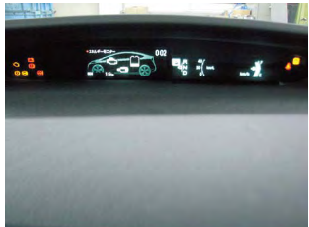
写真4 電源ポジションIG状態のコンビネーションメータ
