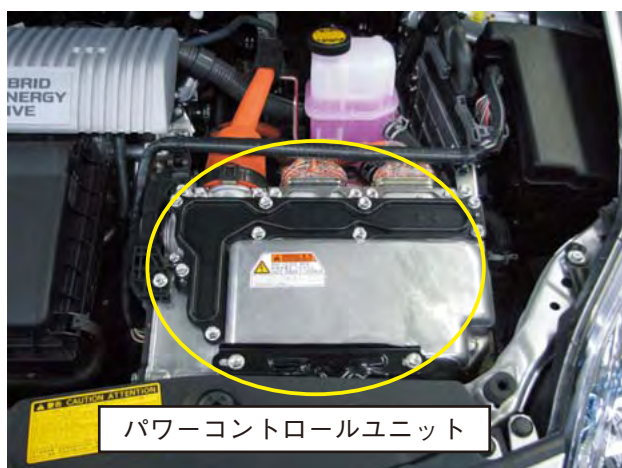
写真9 パワーコントロールユニット
