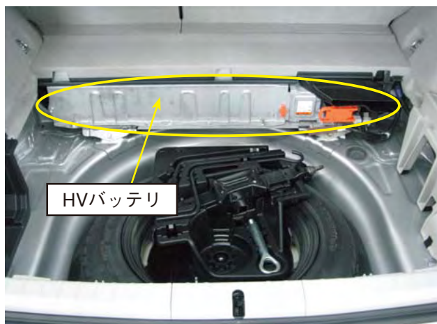
写真6 HVバッテリー
