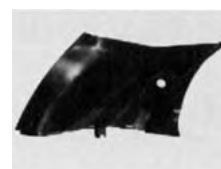
(b) クォータアップトリム(PLA射出成形材)
