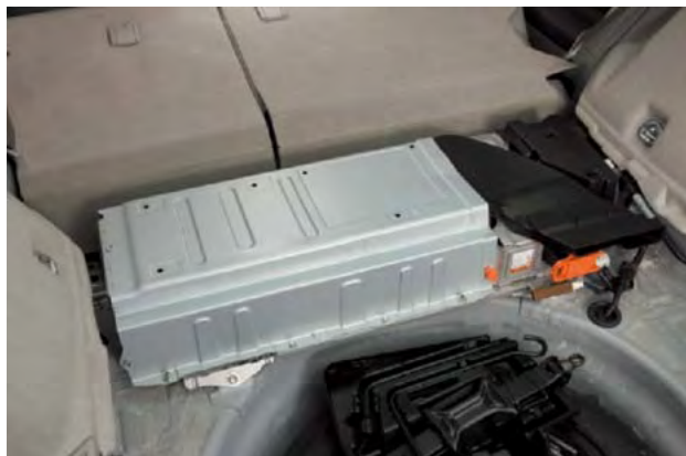
4：6の分割可倒式リヤシート、現行から約30L拡大したラゲージスペース（写真右は、リヤシートバック後側に格納されるニッケル水素電池）。
