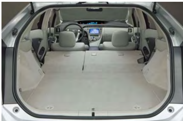
4：6の分割可倒式リヤシート、現行から約30L拡大したラゲージスペース（写真右は、リヤシートバック後側に格納されるニッケル水素電池）。
