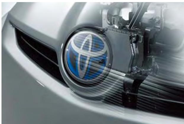
車両検知用のミリ波レーダをフロントのトヨタエンブレムに内蔵する（右写真は先行車両への追突を防ぐプリクラッシュセーフティシステムの動作画面）。
