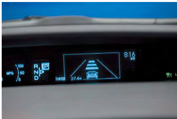
車両検知用のミリ波レーダをフロントのトヨタエンブレムに内蔵する（右写真は先行車両への追突を防ぐプリクラッシュセーフティシステムの動作画面）。
