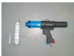
1K取付け用接着剤（D190 接着剤）※ 品番：D 190 MKD A3 コンプレッサーエアガン SST品番：VAG 1761/1
