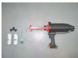
2Kボディ用接着剤（D180 接着剤）※ 品番：D 180 KD3 A2 ダブルカートリッジガン SST品番：VAS 5237
