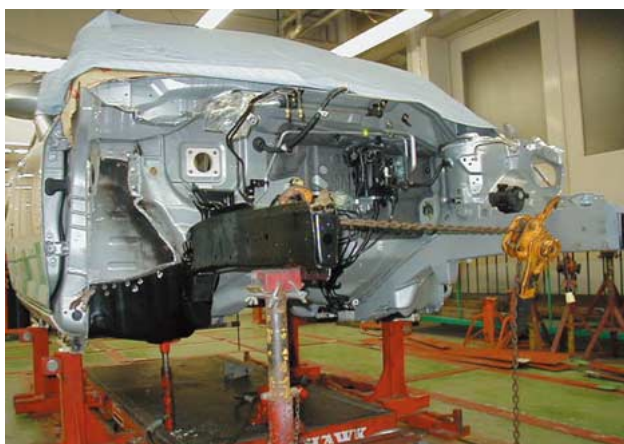
写真9 GD#型 フロントサイドフレーム仮付け状態
