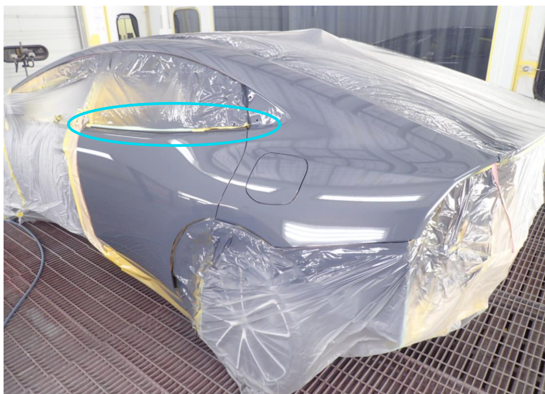
クリヤ塗装後の状態（車両後方より撮影）：乾燥初期に見切り部のマスキングはがし
