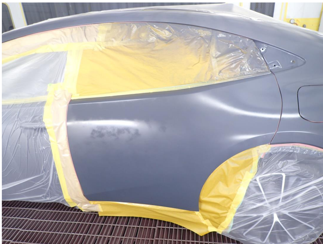
カラーベース塗装後の状態：塗装直後で塗膜に水分がありウェット状態
