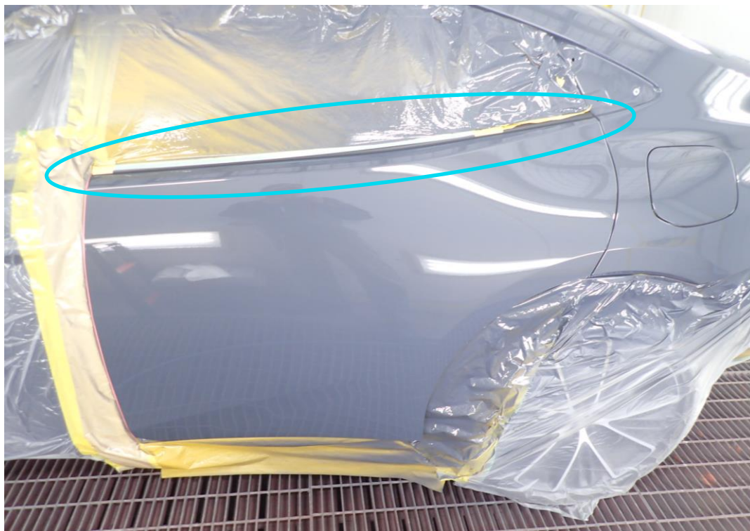
クリヤ塗装後の状態：乾燥初期に見切り部のマスキングはがし
