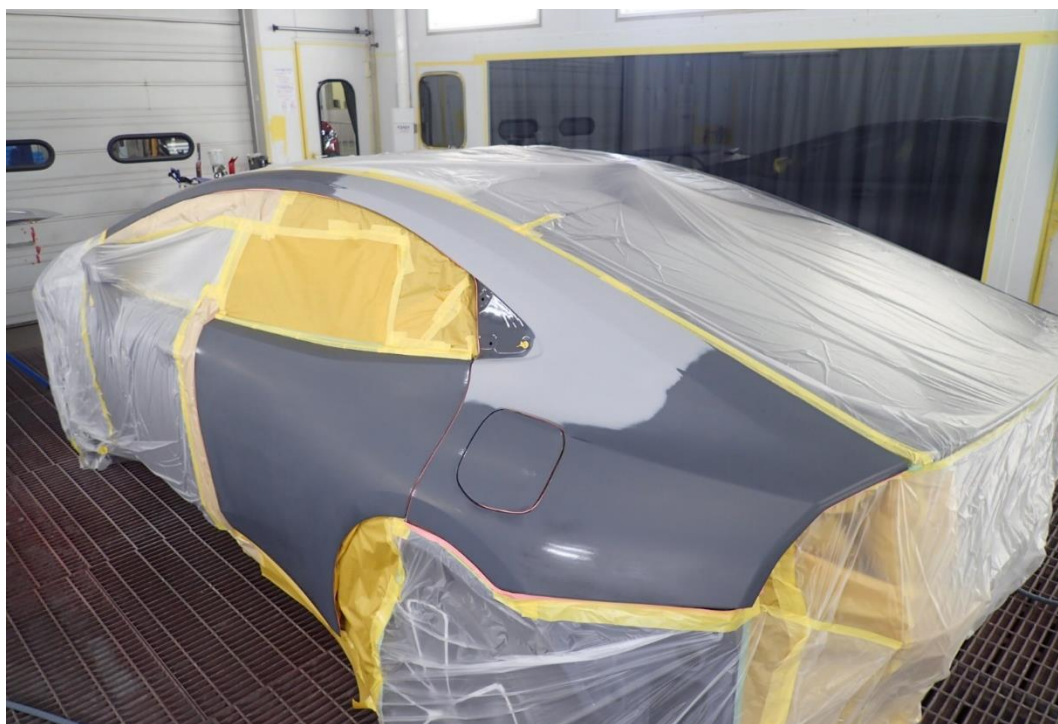
プラサフ研ぎ、ぼかし部足付け後に上塗り用マスキングをした状態
