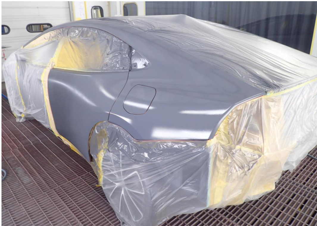
カラーベース塗装後の状態（車両後方より撮影）：ウェット状態
