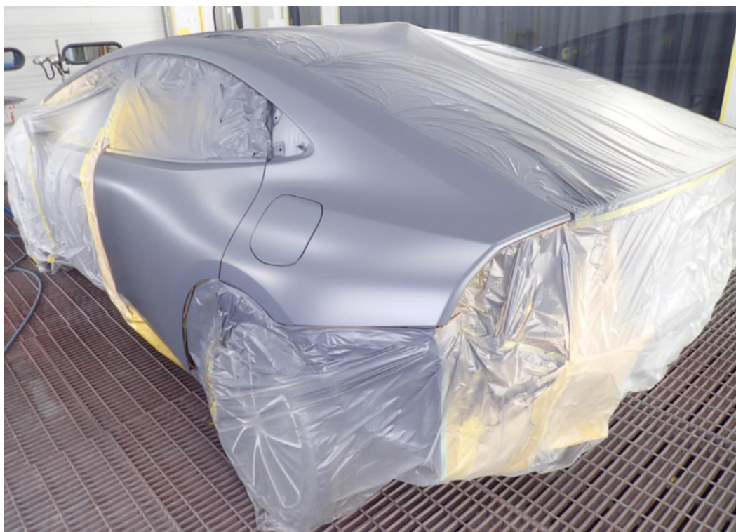
カラーベース塗装後の状態（車両後方より撮影）：ドライ状態（つや消し状態）
