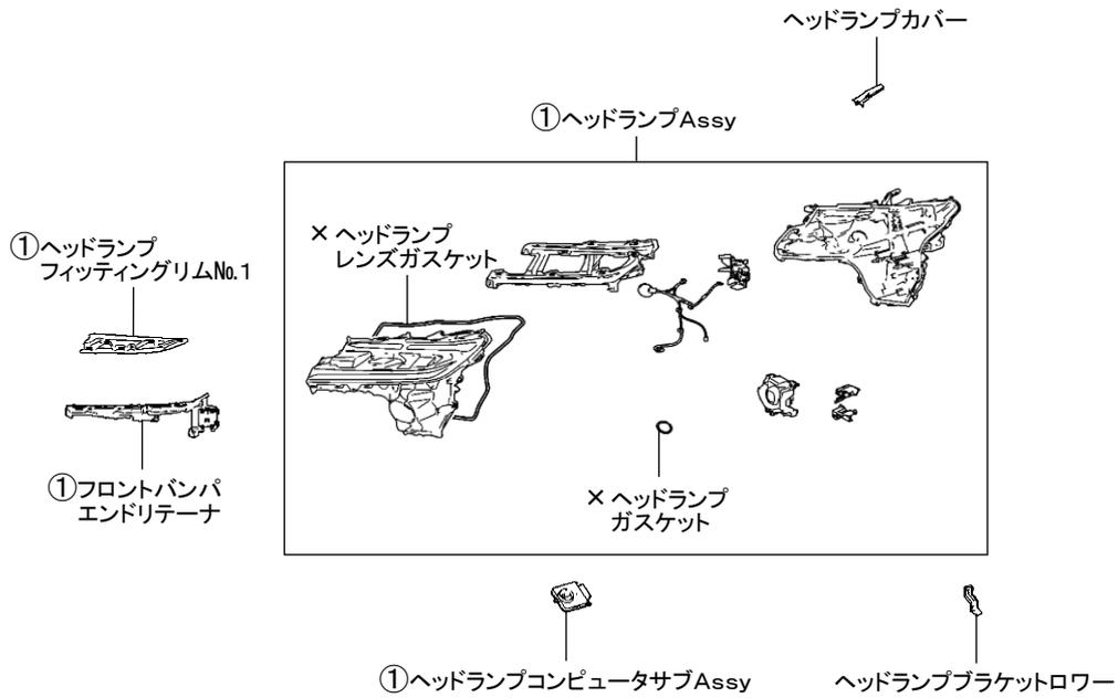
片側ヘッドランプレンズサブAssy、片側ヘッドランプハウジングサブAssy取替
