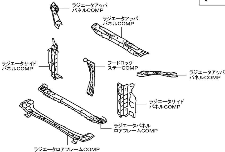
両側ラジエータサイドパネルCOMP、ラジエータアツパパネルCOMP、
