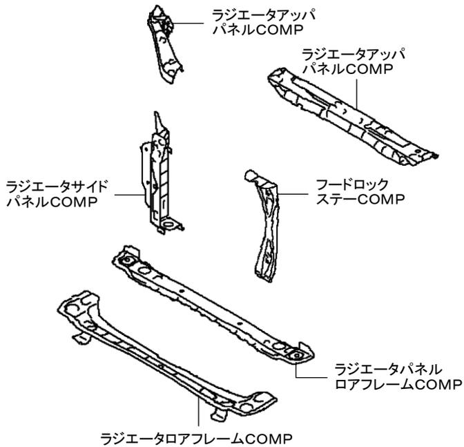
片側ラジエータサイドパネルCOMP、ラジエータアツパパネルCOMP、
