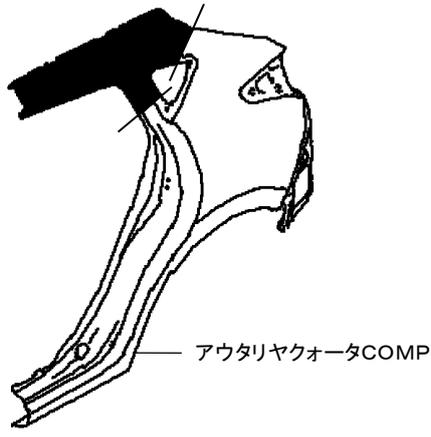
片側アウトリヤクォータCOMP、片側リヤクォータエンドCOMP、片側DピラーエクステンションCOMP取替
