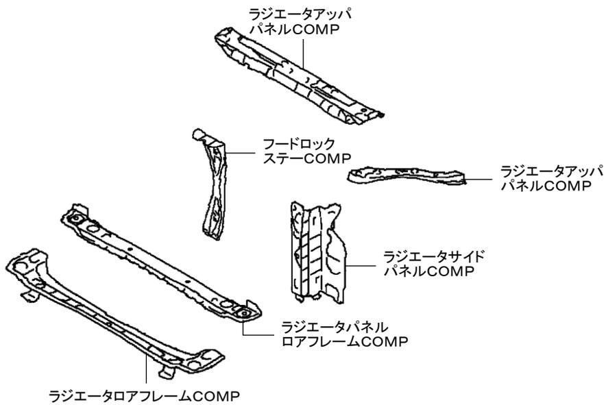
片側ラジエータサイドパネルCOMP、ラジエータアツパパネルCOMP、
