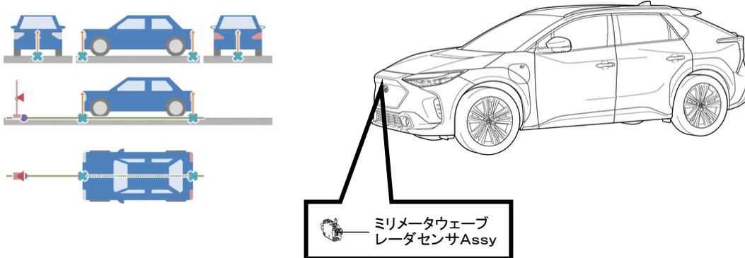
(2)ミリメートルウェーブレーダセンサAssyターゲット調整作業(平面ターゲット)
