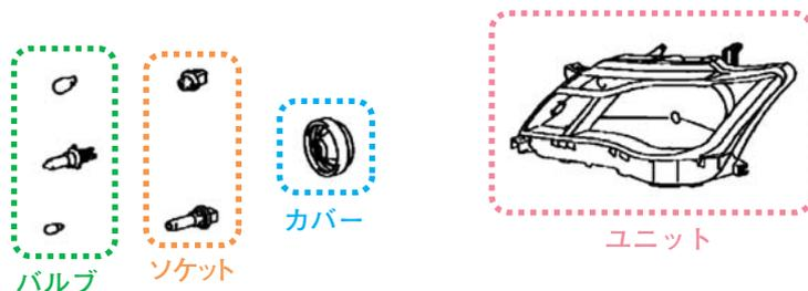
図1 ヘッドランプの主な構成部品
