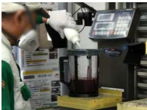
②調合した塗料をテストピースに塗布します。
