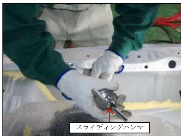
(6) ハンマとドリーで細部の修正を行った後、部分的にパテで成形し修正作業を完了しました。
