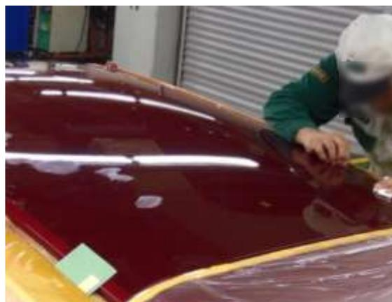
⑬ブツを除去した後にポリッシャを使用して磨き作業を行います。
