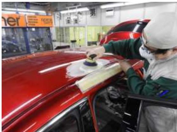
②パテを充填して成形を行い、乾燥させた後にパテ研磨を行います。
