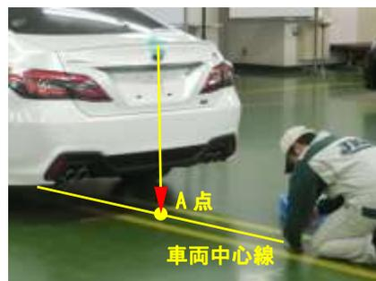
e. 出力した台紙を車両中心線と A 点を合わせて床に貼付ける
