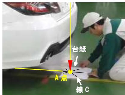
f. ひもを線 C に沿うように貼付け、A 点からの長さが 3403 mm になる位置 (D 点) にマーキングする
