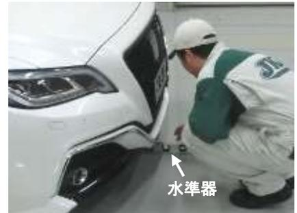
② ミリメータウェーブレーダセンサ Assy 上下左右軸調整
