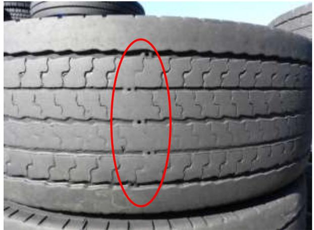
デプスゲージを使用し、縦溝ライン数箇所の残溝を計測し平均残溝深さを算出します。
