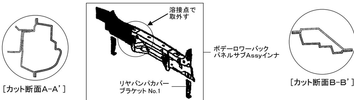
**片側クォータパネル、片側クォータパネルエクステンションアウト、ボデーローバックパネルアウト、ボデーローバックパネルサブAssyインナ取替**
