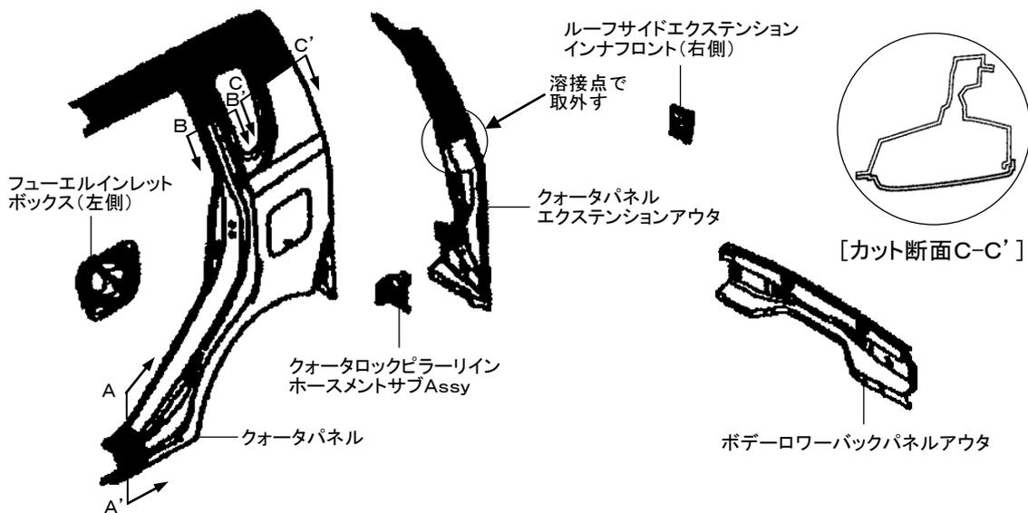
**片側クォータパネル、片側クォータパネルエクステンションアウト、ボデーローバックパネルアウト取替**
