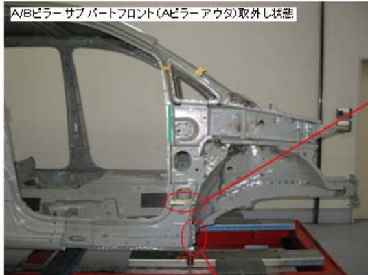
A/Bピラー サブパートフロント (Aピラーアウタ) 取外し状態
