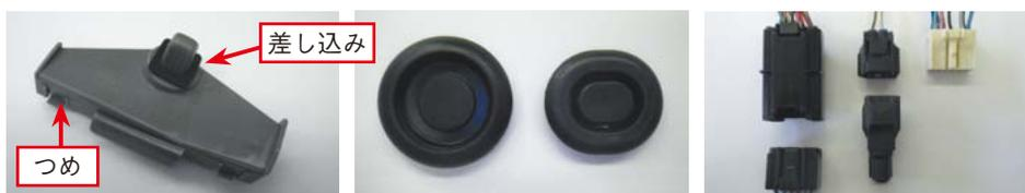
スナップ結合は、プラスチック部品等を結合、固定するものですが、軽量で安価、かつ簡単に脱着が可能など利便性も良く、効率的な手段として広く用いられています。主に、分割ハウジングの結合接合、プラグ、コネクタ、ハウジング等の固定に使用されています。伸張性があること、比較的強度が低いプラスチックの特性を利用したものです。スナップ結合では、弾性要素を結合プロセスとして取り入れ、位置決めラグの裏側にはまり込む前に、一時的にたわむ機械的性質があります。スナップ要素の結合角度により、壊さなくても取外し可能な場合と壊さなくては取外しできない場合があります。
