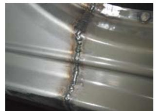
連続溶接は突合せ継手によく用いられる溶接法で、二つの部材(母材)をほぼ同じ面内で突合せて、開先(グループともいい、溶接する母材間に設ける溝)を設けて行う溶接を、連続的に行うものです。
