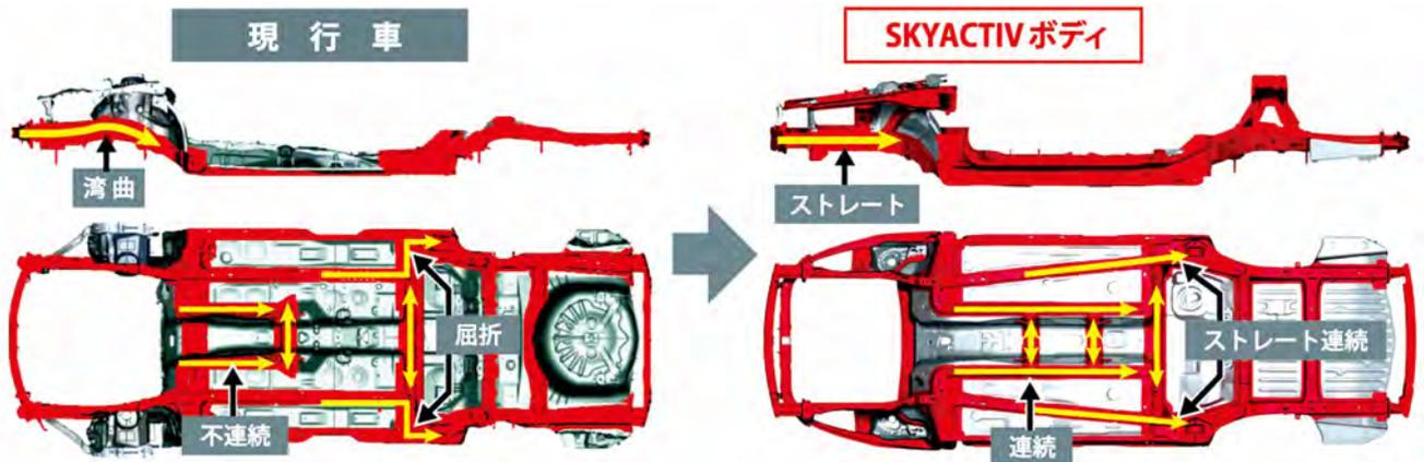
図5 基本骨格のストレート化、連続化技術
