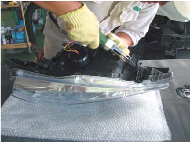
使用工具：ミニエアソー（写真5参照）
