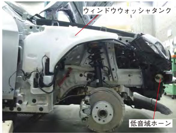
\*左側フロントフェンダ取外しの際、タイヤおよびドアシルカバーの取外しは不要。
