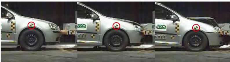
図7 車両側面のターゲット
