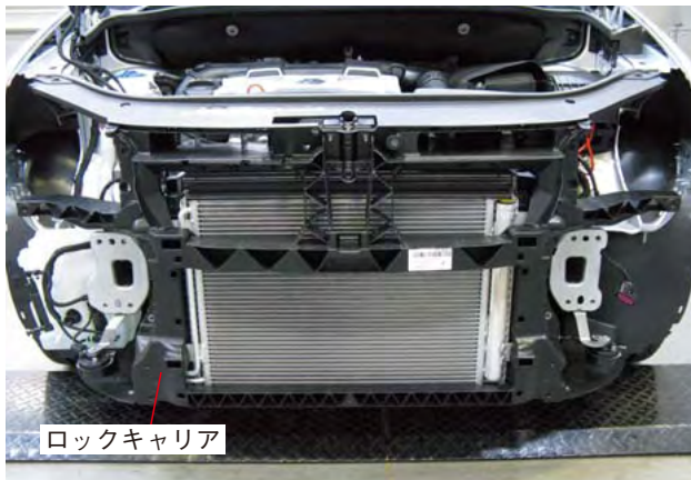
エアコンコンデンサ、チャージエアクーラ、ラジエータ取外し状態
