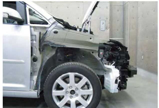
右側フロントフェンダ取外し状態
