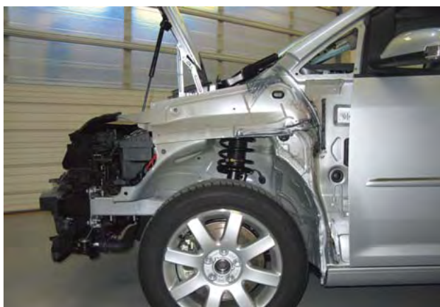
左側フロントフェンダ取外し状態
