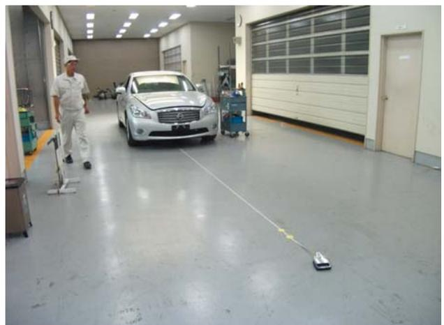
ターゲットボードに定規を取り付け、所定位置に振下げ錘を垂らし、3.9m地点のマーキングに合う様にターゲットボードを配置する。振下げ錘の糸と車両前後ガラスの中心が合うようにターゲットボード位置を微調整し正対させる。
