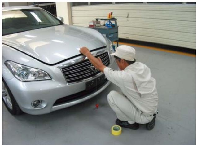
前・後の中心点を結ぶ車両中心線を引き、車両前方3.9mの位置にマーキングする。
