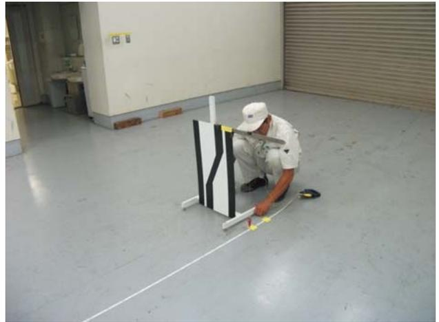
ターゲットボード中心から振下げ錘を垂らし、ターゲットボード中心位置をマーキングする。
