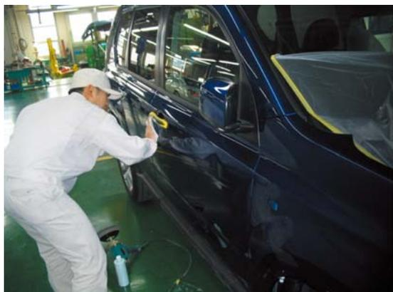
5. 耐スリ傷性クリヤとスクラッチシールドの作業工程比較
