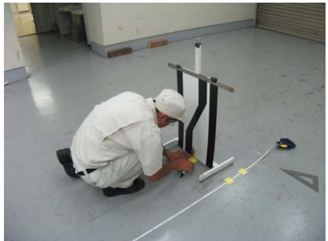
マーキングを中心にターゲットボードを約25°回転させる。(回転方向は左右どちらでも可)
