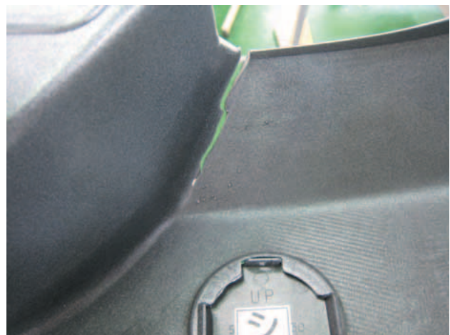
裂傷損傷の裏側
