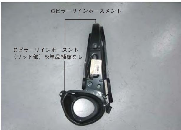
右側Cピラーラインホースメントの補給部品に取付いているリッド部は単品での補給が設定されていないため、Cピラーラインホースメントからリッド部を取外して使用します。
