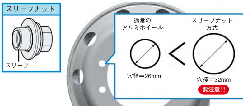
\* 1:主に、欧州車などで採用されており、ホイールのボルト穴径が、通常のホイール(26mm)より、大きくなっている。
