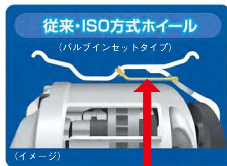
ブレーキ装置とバルブシステムが干渉して破損する恐れがあります
