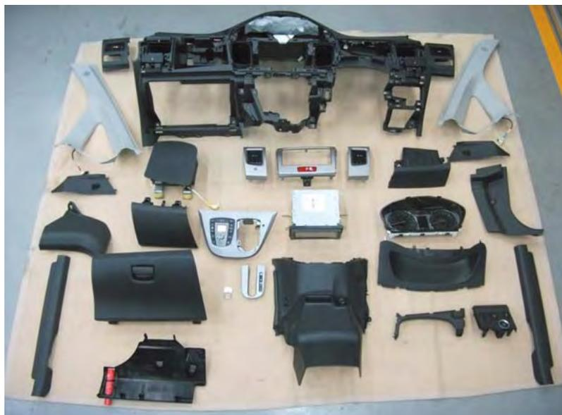
※クリップ、樹脂ツメ、スクリュ等が強固に取付いているため、プラスチックのリムーバツールなどを使用し、部品本体を破損しないよう注意してかん合を取外します。
