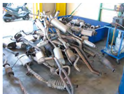
Eng コンピュータや触媒からはレアメタルを取出し再利用
