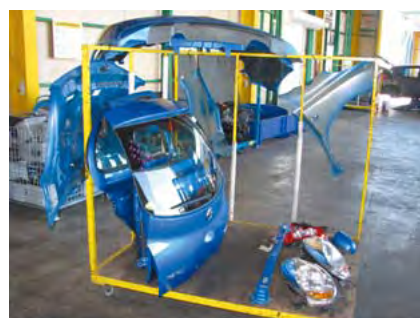
部品取外し工場では部品の状態を点検しながら丁寧に取外す
