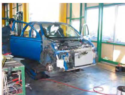
部品取外し工場では部品の状態を点検しながら丁寧に取外す
