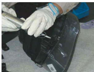
ヘッドライトリペアキットに合わせて損傷部を切断する。
