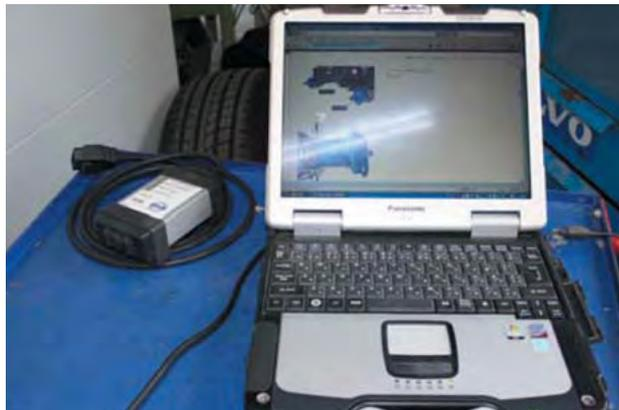
初期設定作業の特徴として、国産車のレーダ較正作業のようにターゲットを設置し工場内で行うものではなく、実走行で自動較正を行うことが作業の特徴です。
