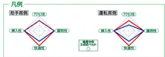
赤線はシートポジションが標準位置、青線はシートポジションを前方に移動した位置における評価を表しています。
