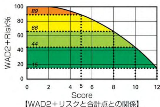
ただし、この傷害確率は、速度変化時速17.6km（同一質量の自動車が停車中の自動車の時速約32kmで衝突した際の衝撃を再現）、かつ、乗員が座席に標準の状態を着座している際の傷害値を基に算出しており、実際の後面衝突事故において、衝突速度が相違する場合、質量の相違する自動車が後突した場合や乗員の乗車姿勢・体格、座席の調整位置の相違により異なることがありますのでご注意ください。
