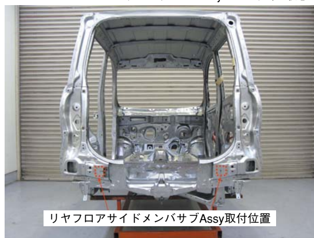
写真7 リヤ正面ボデーローバックパネルサブAssy、 ボデーローバックパネルサブAssyインナ取外し状態
