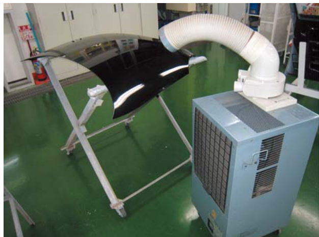
スポットエアコンによる冷却イメージ
