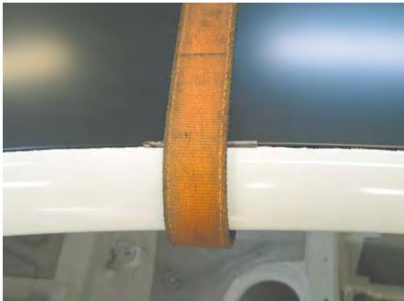
ルーフとサイドパネルアウトの高さ寸法を  $\phi 4.5 + 1.5\text{mm}$  にする。寸法を点検するために  $\phi 4.5\text{mm}$  のドリルを使用する。
