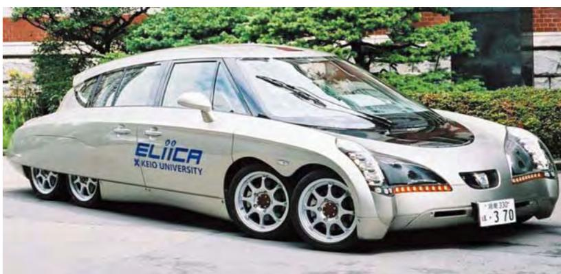
全ての車軸に挿入されたモータが車輪を回転させるタイプの「ELICA (慶応義塾大学電気自動車研究室)」。モータ出力は1個当たり約100馬力。8個のモータで800馬力。スタート時から時速約90kmまで0.68Gの加速度で加速 (物が落下する時の重力の0.68倍)、最高速度は370km/h。
