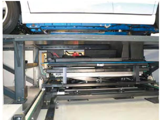
交換ステーションの所定の位置に対応電気自動車 (EV) を停車すると、制御システムとBluetoothで無線通信を行い、その情報を基に、まず底面に装着してあるバッテリーを外し、次に倉庫から対応する充電済みバッテリーを選んで装着する仕組み。
