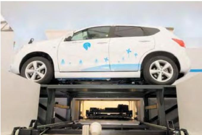
ベタープレイス社が提案するバッテリー交換ステーション。バッテリーは対応電気自動車 (EV) の底面に取り付ける構造で、自動制御によって約1分30秒で取外しと充電済みバッテリーの取付けを完了する。上の写真で車両下部の奥に見えるのがバッテリーを積んだ台車。
